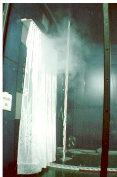
*Figur 4-15: F-SH-O, HK (190 W) und mit dünnem Tagesvorhang, Zulufttemperatur 2 °C*
