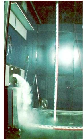
Figur 4-10: Heizkörper ausgeschaltet, kleine Diskomfortzone nahe beim Durchlass
