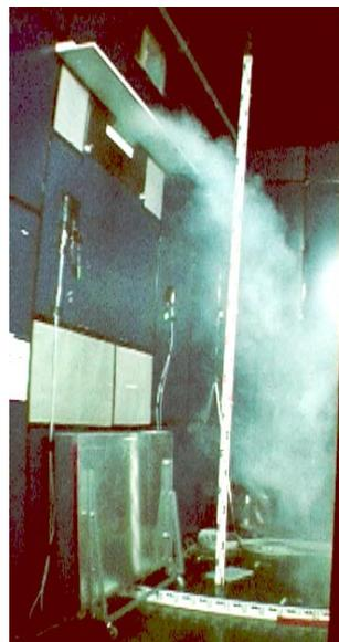
*Figur 4-13: F-SH-O, HK ausgeschaltet, Fensterbrett, Zulufttemperatur 2 °C*
