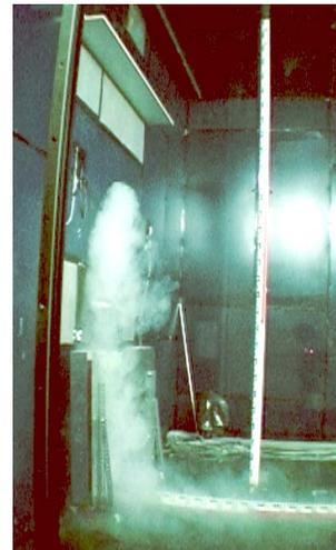
Figur 4-9: Die Eindringtiefe der Diskomfortzone wird bei der Anordnung „unten“ etwas kleiner, jedoch ist das Zugluftisiko entlang dem Boden etwas grösser, Wärmequelle: FBH, Heizkörper ausgeschaltet.
